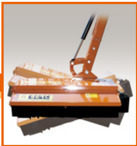
大径ゲージローラーにより、地面形状に合った動きをします。(フローティングシステム)
