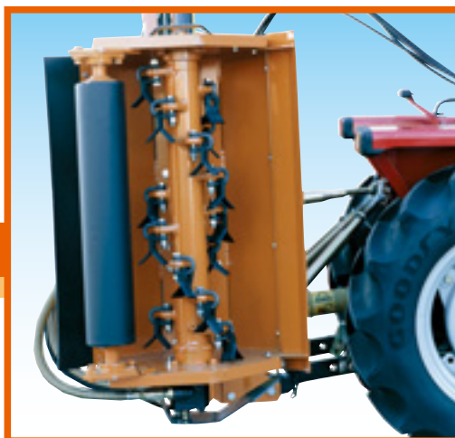
Yブレードはシャックルで取り付けられ、衝撃にも強く、3cmの太さの木まで破碎できます。またカッティングヘッドは大径ゲージローラーにより地面形状に合った動きをします（フローティングシステム）
