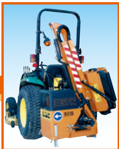
移動時はコンパクトに収納できます。油圧内蔵で、操作は手動リモコンが標準装備。ご使用トラクタを選びません。
